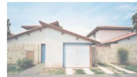
Traitement spécifique au sol alliant bandes de roulement en béton et pelouses
